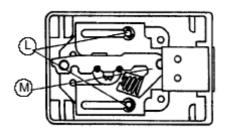
Выверните винты и снимите заднюю пластину замка. Закрепите пластину на двери с помощью 4 винтов 4,8 х 32. Когда цилиндр не зафиксирован (при вынутом ключе) поместите рабочий кулачек (С) в прорезь (D) на задней пластине. Следите за тем, чтобы сцепляющий штифт оставался внизу (арт. 54550, 54560, 54570, 54580). Поместите корпус замка за заднюю пластину и закрепите двумя винтами М5 х 90.
